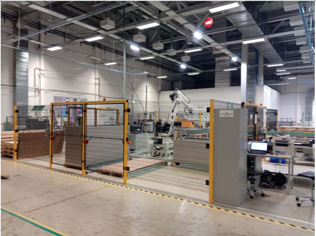
Рис.2 Схема используемого ограждения на линии ВВ.
