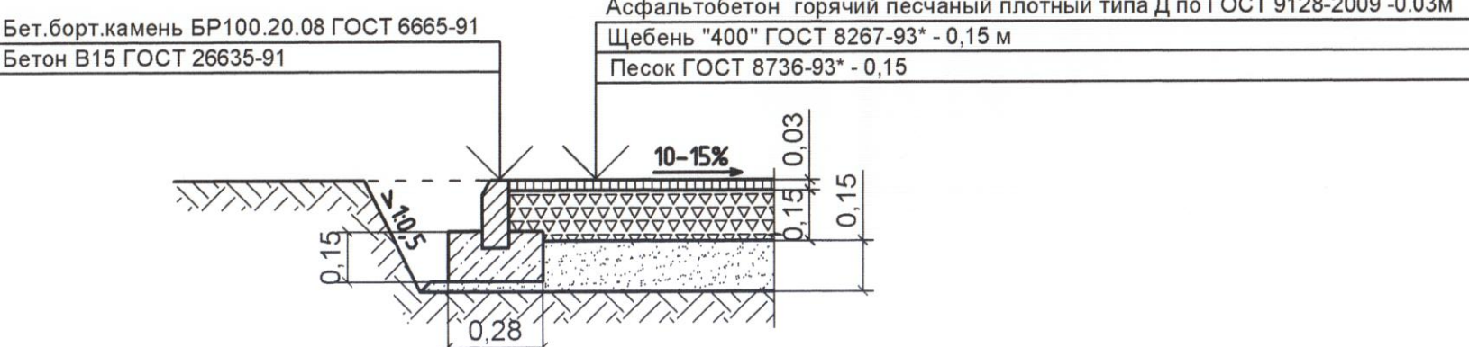
Тип 3 В Конструкция покрытия тротуара
